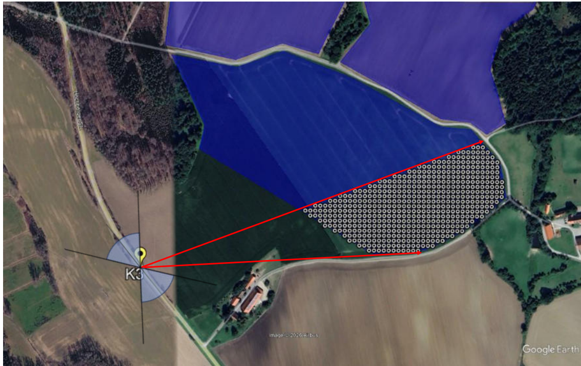
Abbildung 30: Vergleich Sichtfeld Fahrzeugführende für Punkt K3 mit Grenzvektoren in Richtung Module
