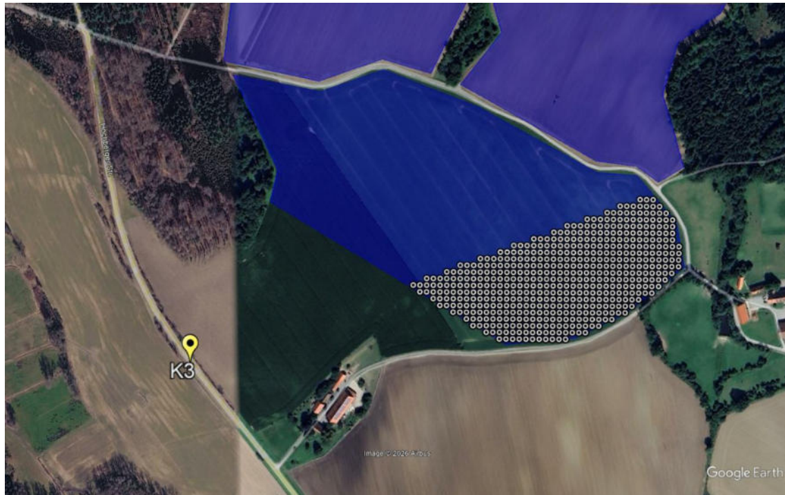
Abbildung 8: Spezifischer Emissionsbereich für Punkt K3 auf der Kreisstraße für alle Modulneigungen
