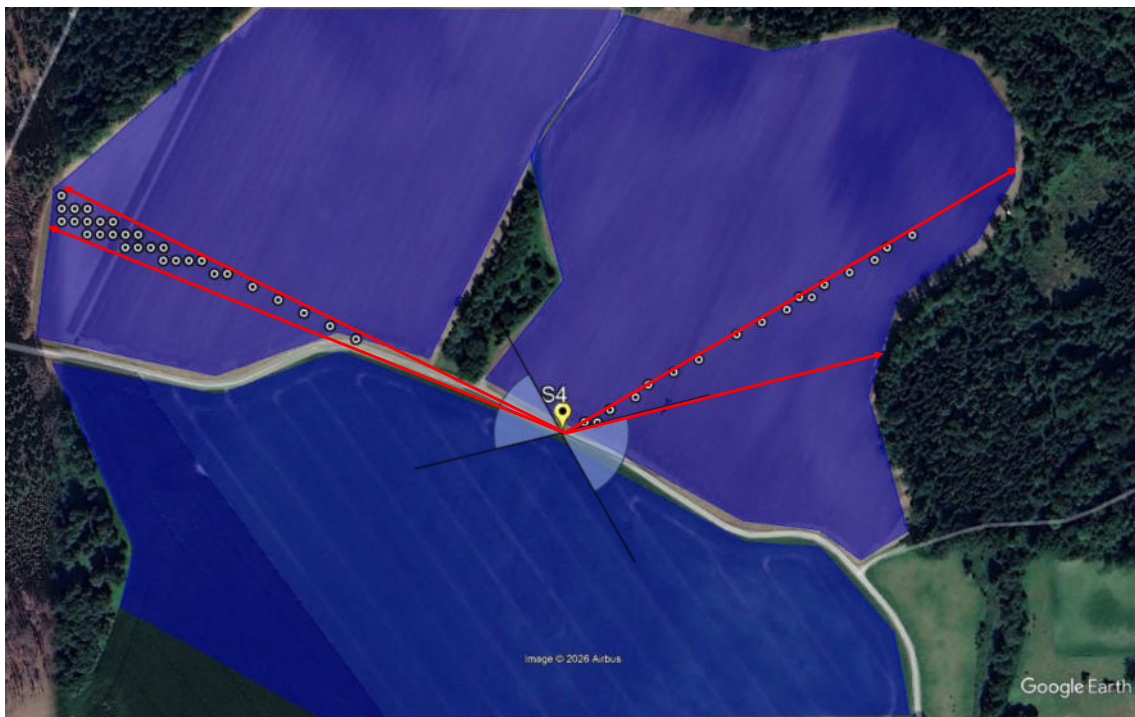
Abbildung 32: Vergleich Sichtfeld Fahrzeugführer*in zu Punkt S4 mit Grenzvektoren in Richtung Module
