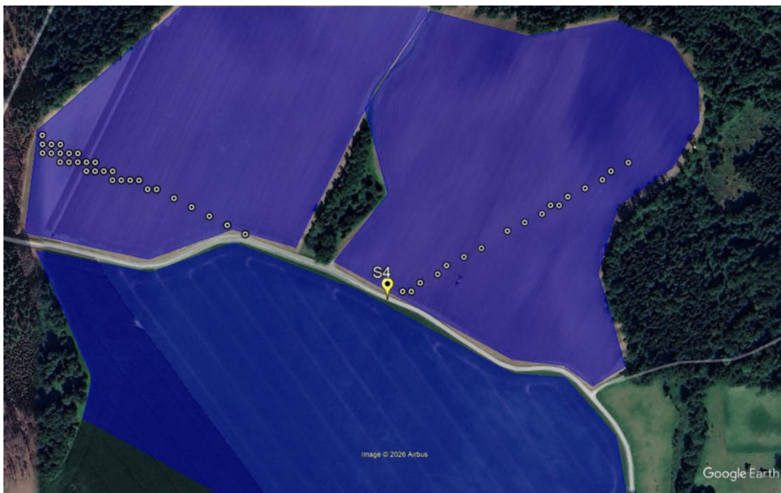
Abbildung 26: Spezifischer Emissionsbereich für Punkt S4 für alle Modulneigungen
